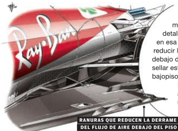
RANURAS QUE REDUCEN LA DERRAME DEL FLUJO DE AIRE DEBAJO DEL PISO
